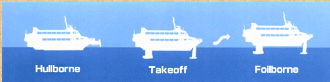
El Jetfoil desde el punto de vista de navegación tiene dos formas de operar, una de ellas es en navegación convencional sobre el casco o HULLBORNE, principalmente utilizada para maniobra en puerto, y otra, la más característica de la embarcación que es volando o sustentándose hidrodinámicamente sobre sus foils o FOILBORNE.
